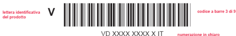
Figura 2: Esempio di layout codice a barre 3 di 9 Assicurato
