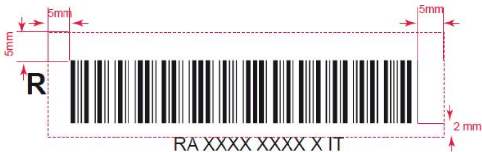
Figura 3: Esempio di layout codice a barre 3 di 9 con area di rispetto
