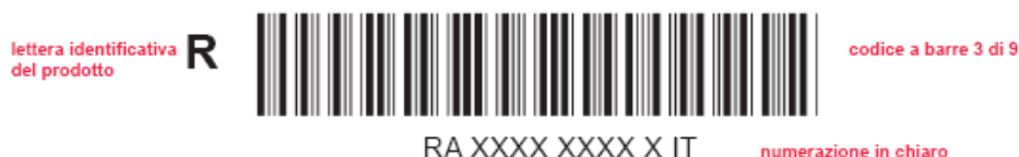
Figura 1: Esempio di layout codice a barre 3 di 9 per il prodotto Raccomandato e Posteminibox Track
