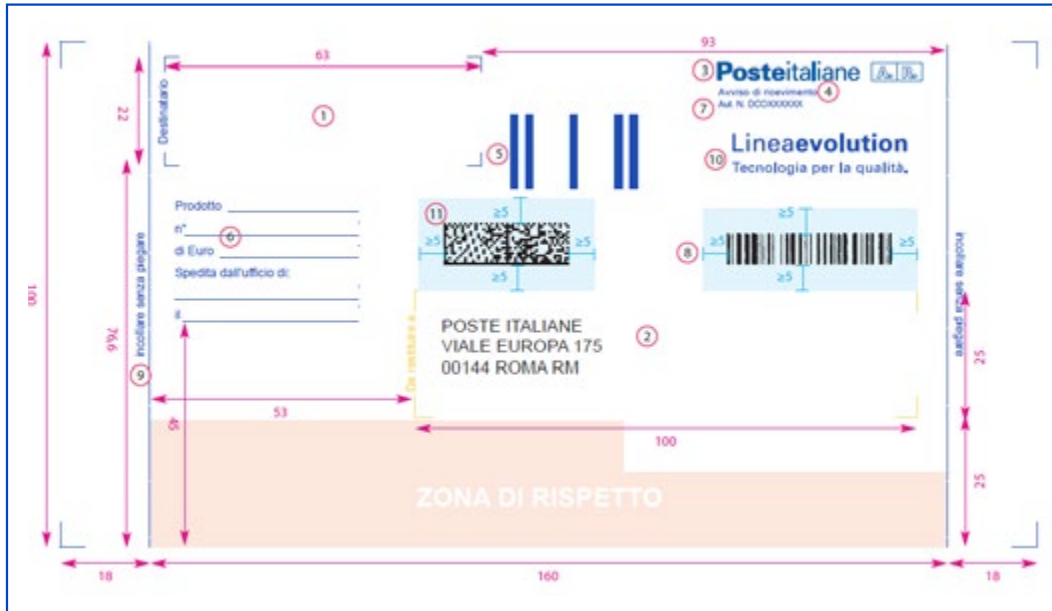
Figura 1: Esempio di fronte cartolina Avviso di Ricevimento modello 23i In rosso la quotatura con dimensioni in mm
